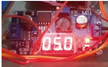
Gambar 12. Hasil Penurunan Tegangan Yang Dilakukan Stepdown
